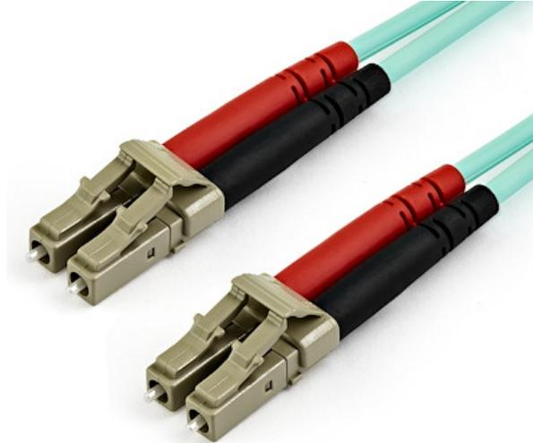
Dieses OM3 LC-auf-LC-Multimodus-Duplex-Glasfaser-Patchkabel verfügt über 50/125 Mikron Glasfaser und unterstützt Datenübertragungen mit hoher Bandbreite über eine 10-Gigabit-Ethernet-Verbindung.
