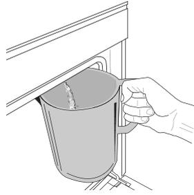
Una volta selezionata la funzione "Scarico acqua", seguire le azioni indicate: aprire la porta e appoggiare una caraffa capiente sotto l'ugello di scarico, situato nella parte in basso a destra del pannello. Una volta iniziato lo scarico, tenere la caraffa in posizione fino al termine del processo. La durata
