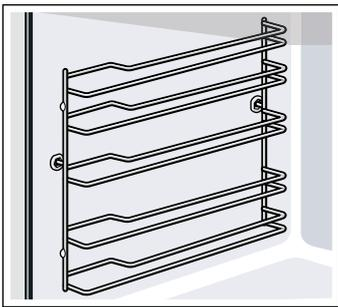
1. Sollevare un po' il supporto anteriore **a** e smontare **b** (figura **1**).
