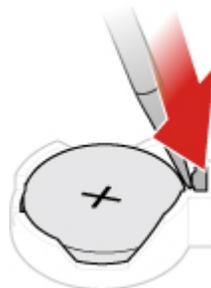
Figura 122. Pressione della linguetta metallica mediante un cacciavite
