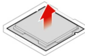
*Figura 117. Rimozione del microprocessore*
