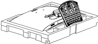
2. (1) Utilice el destornillador para aflojar el tornillo ubicado debajo de la base.
