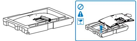
2. (1) Sujete el soporte de la base con ambas manos e inserte firmemente el soporte de la base en la columna de la misma.
