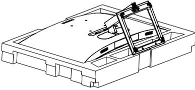
2. Utilice el destornillador para aflojar el tornillo ubicado debajo de la base y quite la base del soporte.
