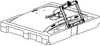
2. Utilize uma chave de fendas para desapertar o parafuso da parte inferior da base e remova a base do suporte.
