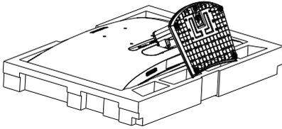
2. (1) Utilize uma chave de fendas para desapertar o parafuso localizado na parte inferior da base.
