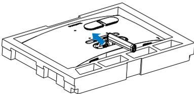
4. Utilize uma chave de fendas para remover os parafusos da coluna e desencaixe a coluna/suporte do monitor.
