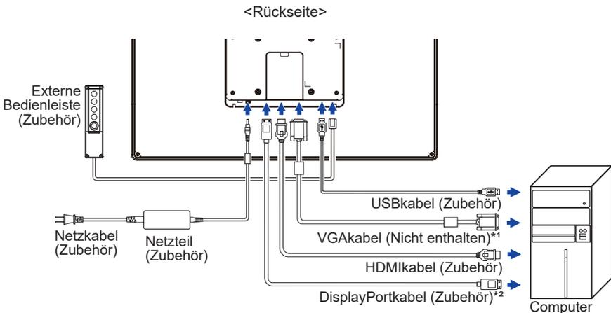
\*1 Das VGA-Kabel ist nicht im Lieferumfang enthalten. Wenn ein qualitativ niedriges VGA-Kabel verwendet wird, kann dies elektromagnetische Störungen verursachen. Bitte kontaktieren Sie das iiyama Support Center in Ihrem Land, wenn Sie den Monitor über den VGA-Eingang anschließen wollen.
