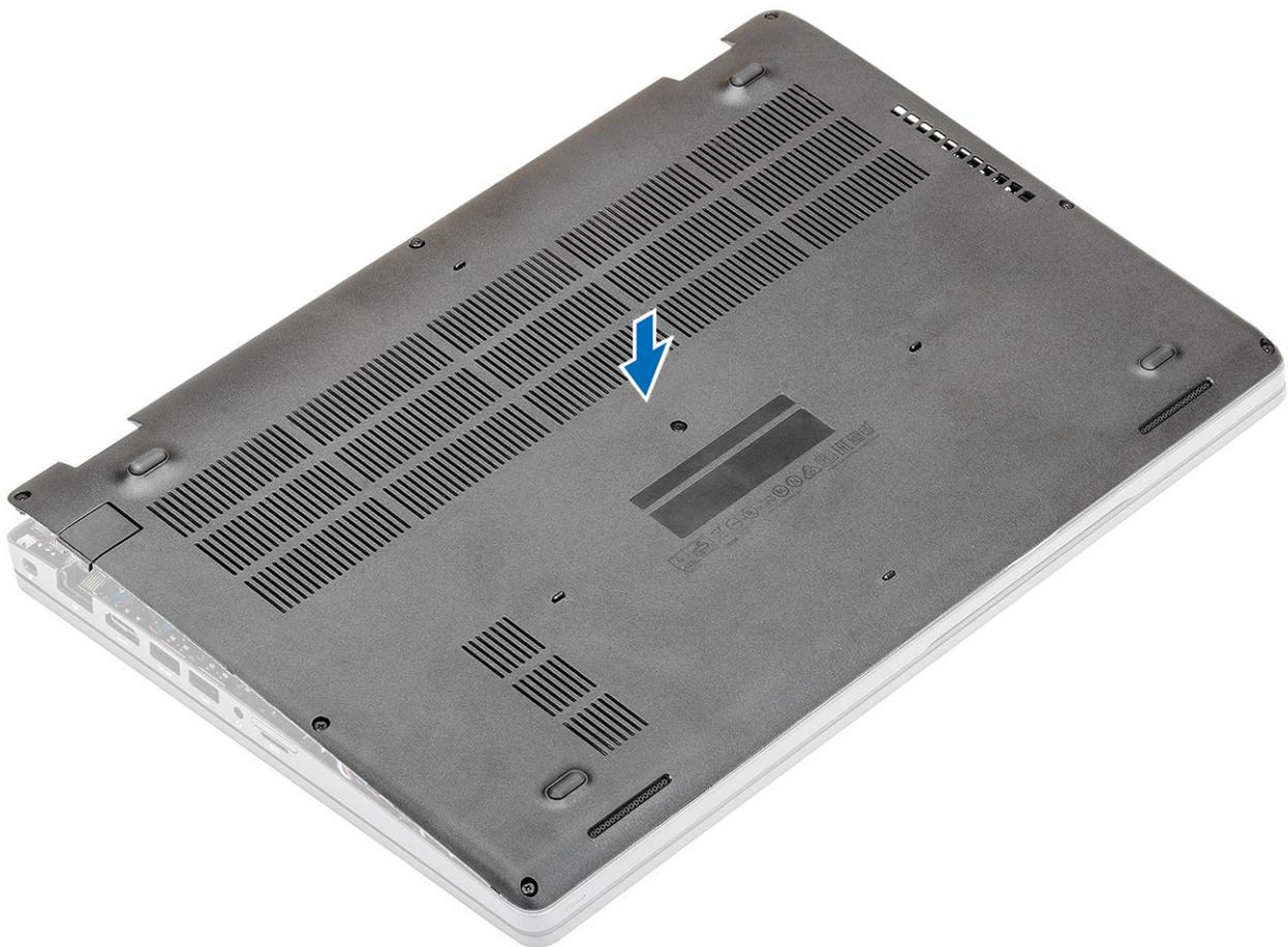
2. Presione los bordes y los laterales de la cubierta de la base hasta que encaje en su lugar.
