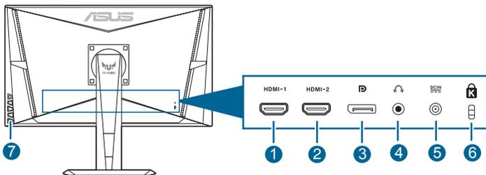
1. **HDMI-Port:** Dieser Port dient dem Anschließen eines HDMI-kompatiblen Gerätes.
