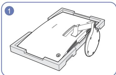
Legen Sie den Styroporrahmen aus der Packung auf den Boden und legen Sie das Gerät mit der Vorderseite nach unten wie abgebildet auf den Styroporrahmen.
