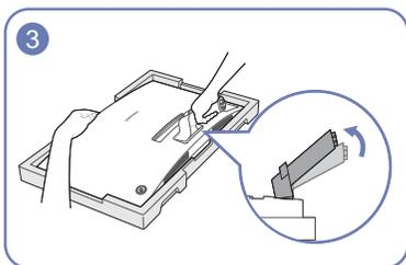
Wenn Sie den Monitor halten, heben Sie die Halterung für den Standfuß in Richtung des Pfeiles an und justieren Sie ihn wie in der Abbildung dargestellt.
