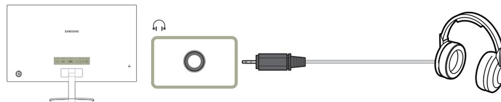
— Verwenden Sie Kopfhörer, wenn Sie den Ton mit einem D-SUB + AUDIO-, HDMI-DVI + AUDIO-, HDMI-HDMI- oder DP-Kabel aktivieren.
