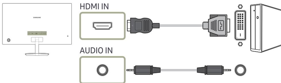
— Die Audiofunktion wird nicht unterstützt, wenn das externe Gerät mit dem HDMI-DVI-Kabel angeschlossen wird.
