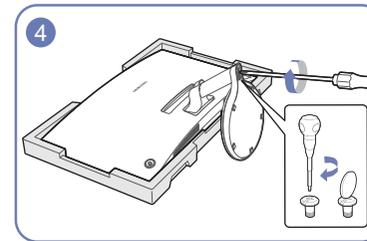
Verbinden Sie den Standfuß mit der Halterung für den Standfuß und bringen Sie anschließend die zwei Schrauben am Fuß an, um ihn fest zu montieren.
