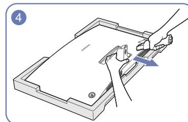
Wenn Sie den Monitor halten, ziehen und entfernen Sie die Halterung für den Standfuß wie in der Abbildung dargestellt in Richtung des Pfeiles.
