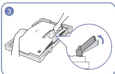
Wenn Sie den Monitor halten, heben Sie die Halterung für den Standfuß in Richtung des Pfeiles an und justieren Sie ihn wie in der Abbildung dargestellt.
