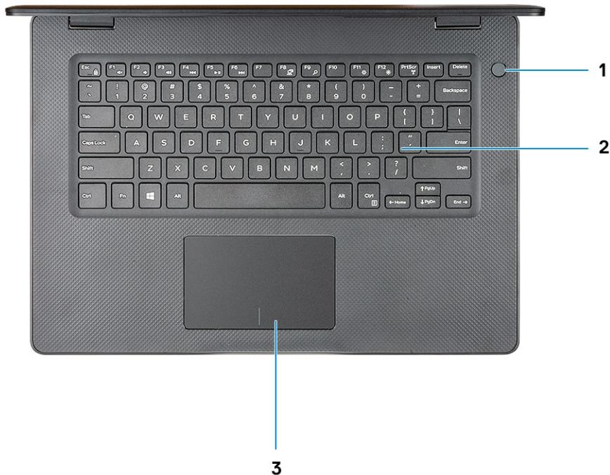
1 Tlačítko napájení s volitelnou čtečkou otisků prstů
