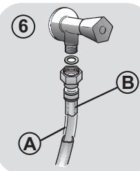
**WASSERSCHUTZ (Abbildung 6):** Sollte Wasser aus dem Hauptschlauch „A“ austreten, schützt die Hülle „B“ vor kompletten Wasseraustritt.
