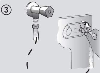
**HEIß&KALT (Abbildung 4):** Wasserverbindungseinstellungen mit heiß und kalt für höhere Energieeinsparungen. Verbinden Sie den grauen Schlauch mit dem Wasserhahn und den roten mit dem Heißwasserhahn. Die Waschmaschine kann auch nur mit dem Kaltwasserhahn verbunden werden: In diesem Fall braucht einige Programme etwas länger, um zu starten.
