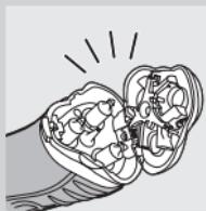
**4** Lukk skjæreenheten og rist av overflødig vann. Tørk aldri skjæreenheten med et håndkle eller tørkepapir. Det kan skade skjærehodene.
