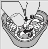
**7** Włóż głowice golące z powrotem do elementu golącego. Następnie załącz element zabezpieczający na swoje miejsce (1) i dokręć blokadę w prawo (2).
