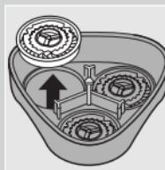
**3** Okrenite kotačić u smjeru obrnutom od smjera kazaljke na satu (1) i izvadite okvir za pričvršćivanje (2).
