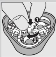
**7** Glave za brijanje vratite u jedinicu za brijanje. Okvir za pričvršćivanje vratite u jedinicu za brijanje (1) i okrenite kotačić u smjeru kazaljke na satu (2).
