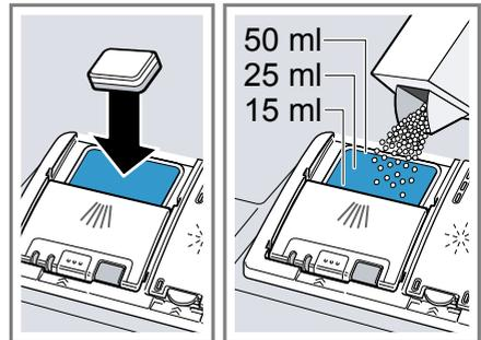
Wenn Sie Tabs verwenden, genügt eine Tablette. Tabs quer einlegen. Wenn Sie Pulverreiniger oder Flüssigreiner verwenden, beachten Sie die Dosierungshinweise des Herstellers und die Dosierungseinteilung der Reinigerkammer. Bei normaler Verschmutzung genügen 20 ml – 25 ml Reiniger. Bei wenig verschmutztem Geschirr genügt eine etwas geringere als die angegebene Reinigermenge.
