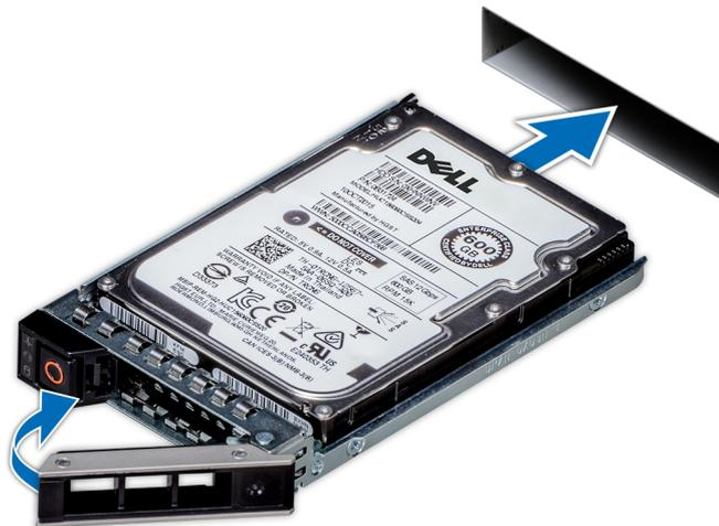
Abbildung 52. Einsetzen eines Laufwerksträgers
