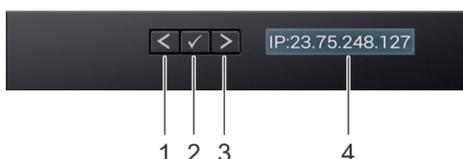
Abbildung 15. Merkmale des LCD-Display
