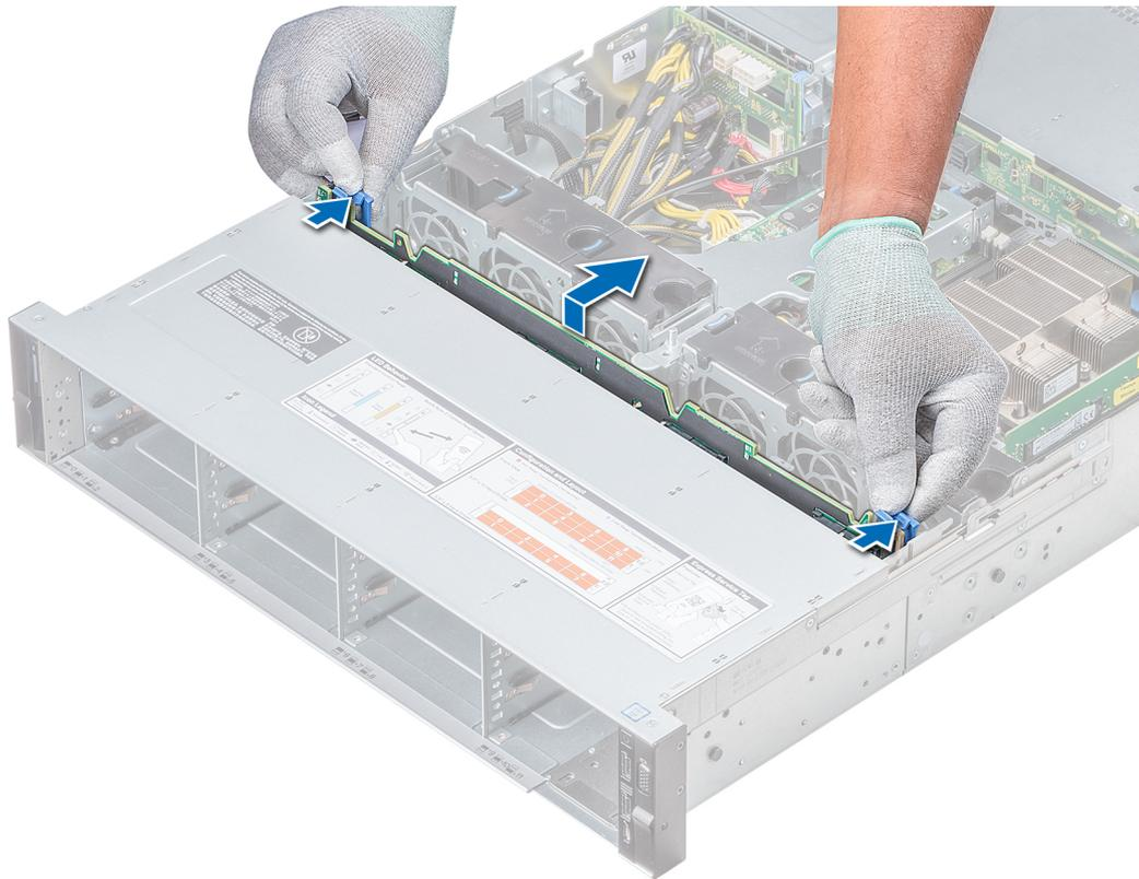
**Abbildung 99. Entfernen der Rückwandplatine**
