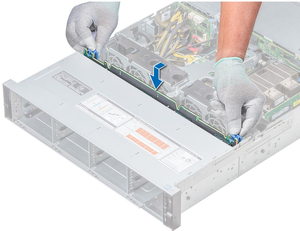
**Abbildung 100. Installieren der Rückwandplatine**
