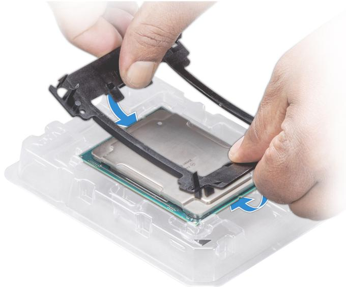
**Abbildung 61. Installieren der Prozessor-Halterung**
