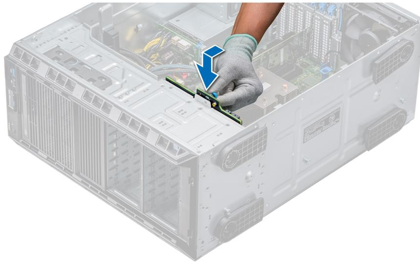
Figure 52. Installation d'un fond de panier de disque dur
