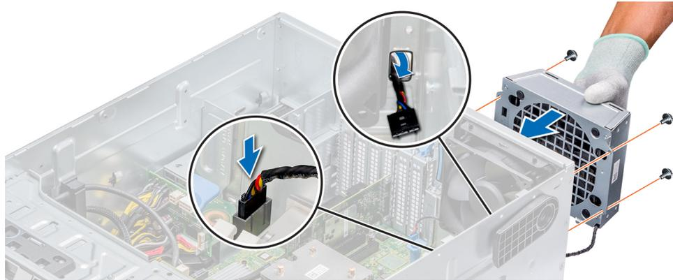
Figure 59. Installation du ventilateur de refroidissement externe
