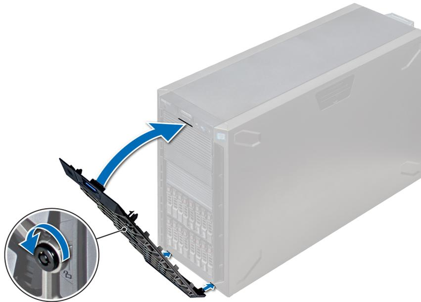
Figure 17. Installation du cadre avant
