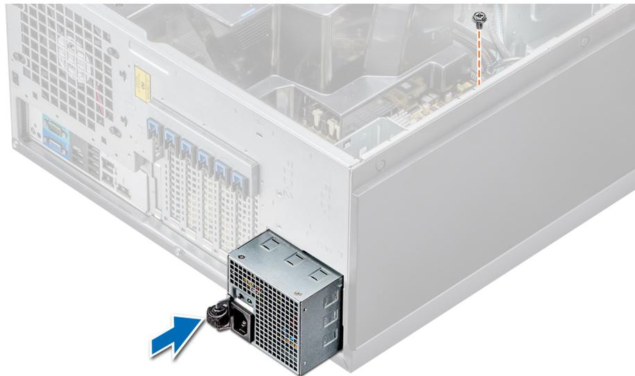
Figure 82. Installation d'un bloc d'alimentation câblé
