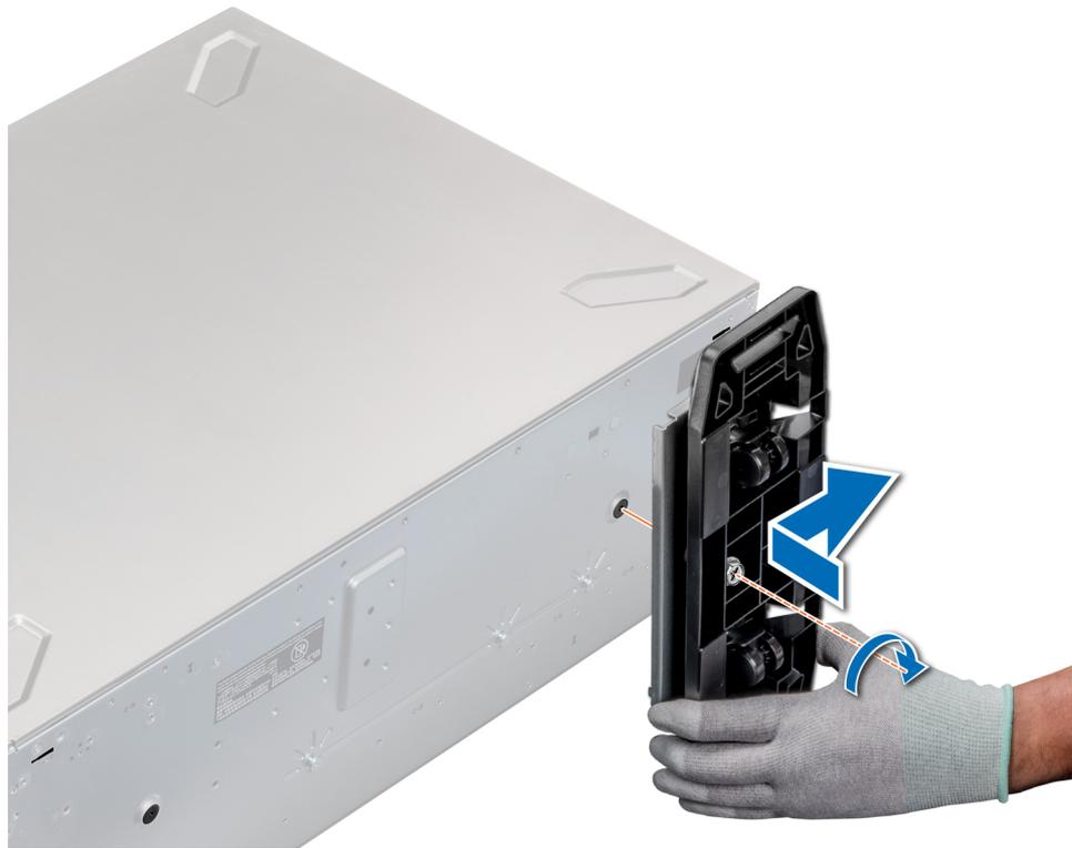
Figure 23. Installation des roulettes
