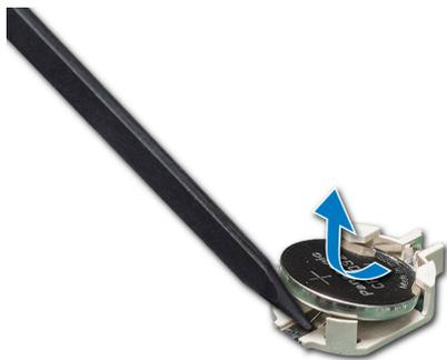
Figure 85. Retrait de la pile du système
