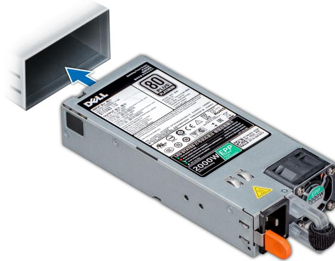
Figure 80. Installation d'une unité d'alimentation
