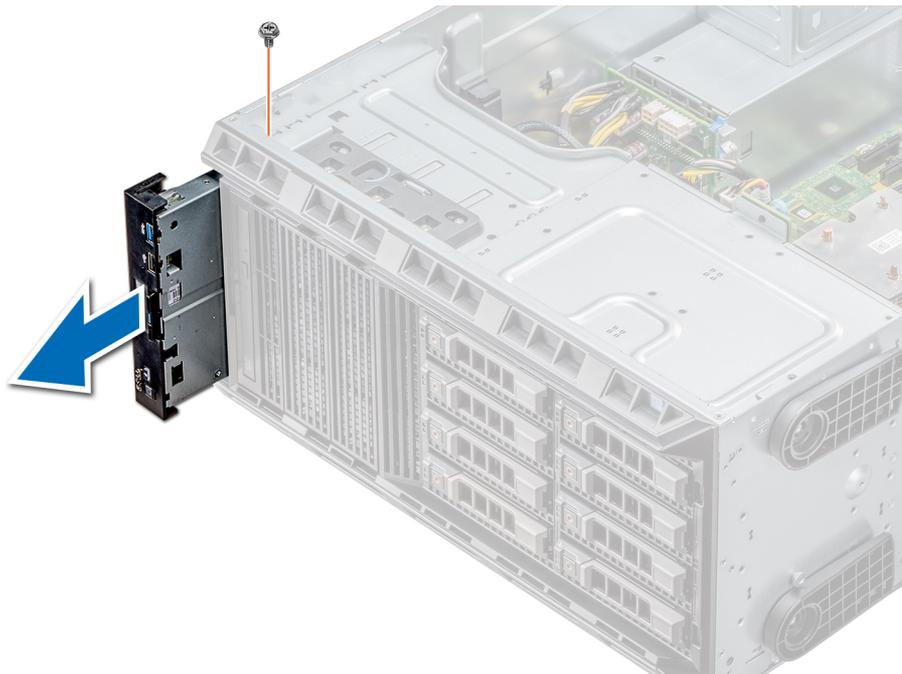
**Figure 87. Retrait de l'assemblage du panneau de commande**
