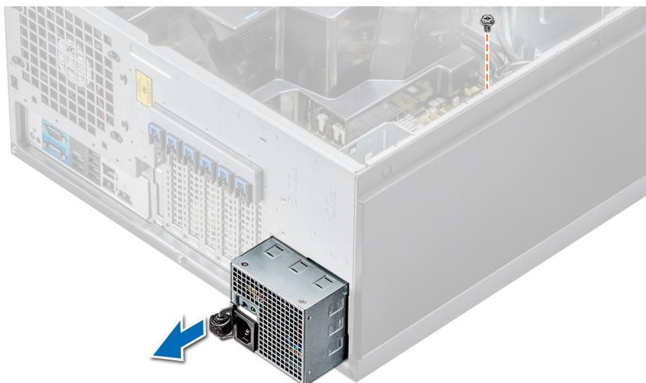
Figure 81. Retrait d'un bloc d'alimentation câblé
