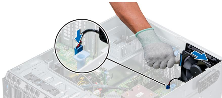
Figure 57. Installation du ventilateur de refroidissement interne
