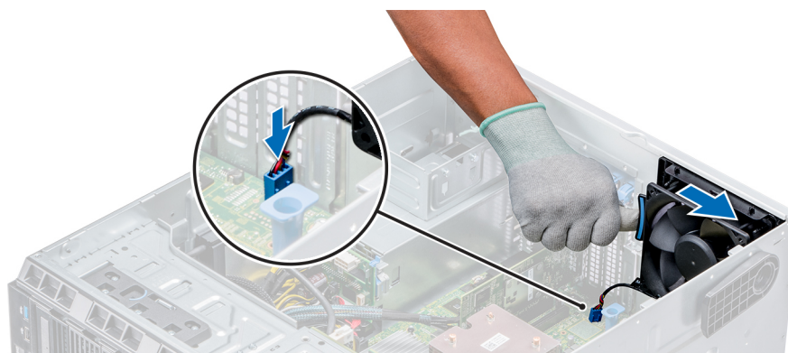
Abbildung 57. Installieren des internen Lüfters
