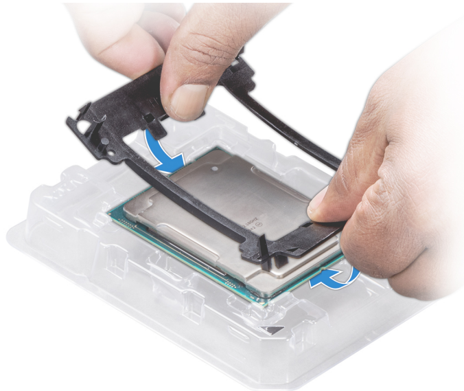
Abbildung 73. Installieren der Prozessor-Halterung
