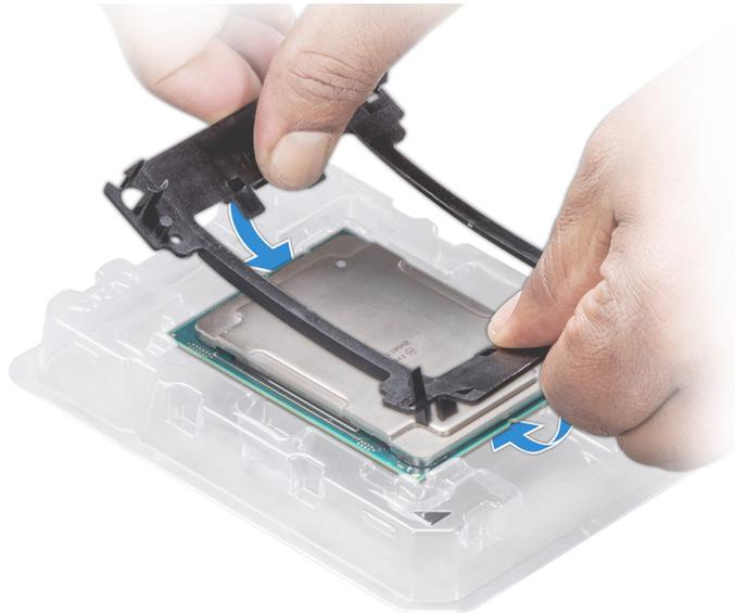
**Figure 69. Installation du support de processeur**
