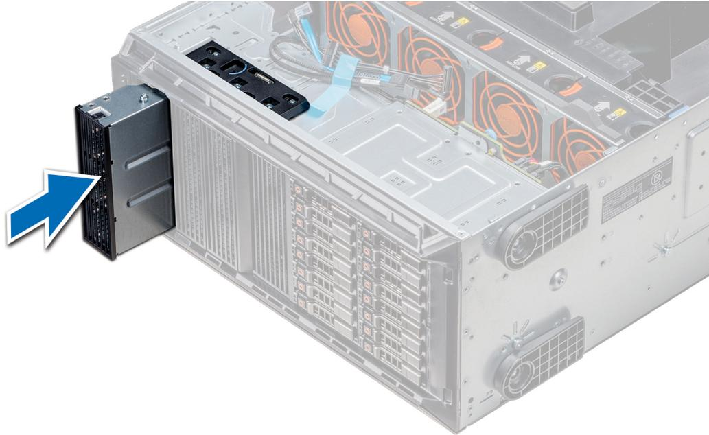
Figure 56. Installation du cache de lecteur optique ou de bande
