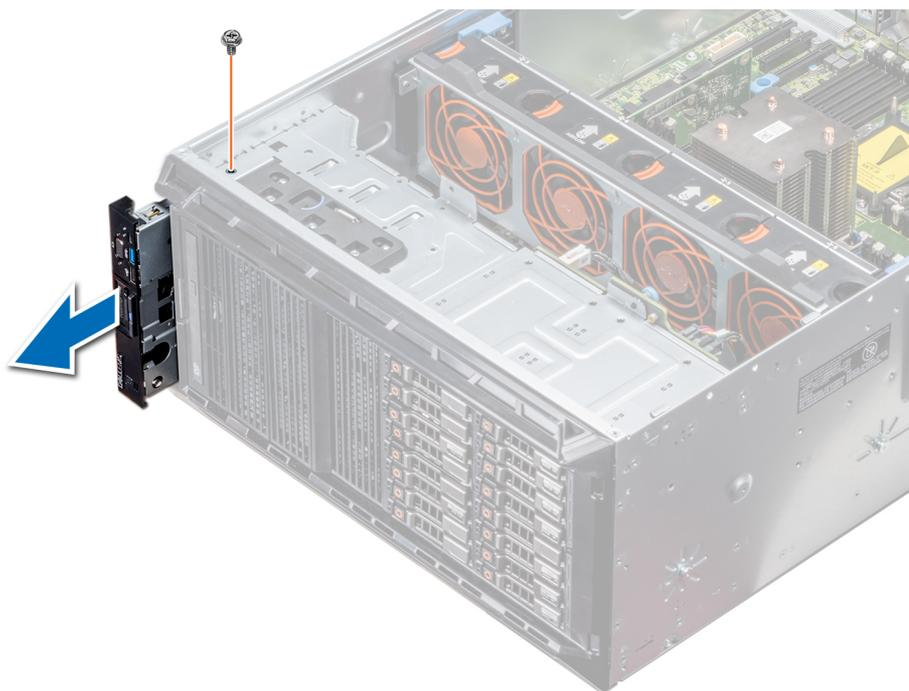
**Figure 100. Retrait de l'assemblage du panneau de commande**
