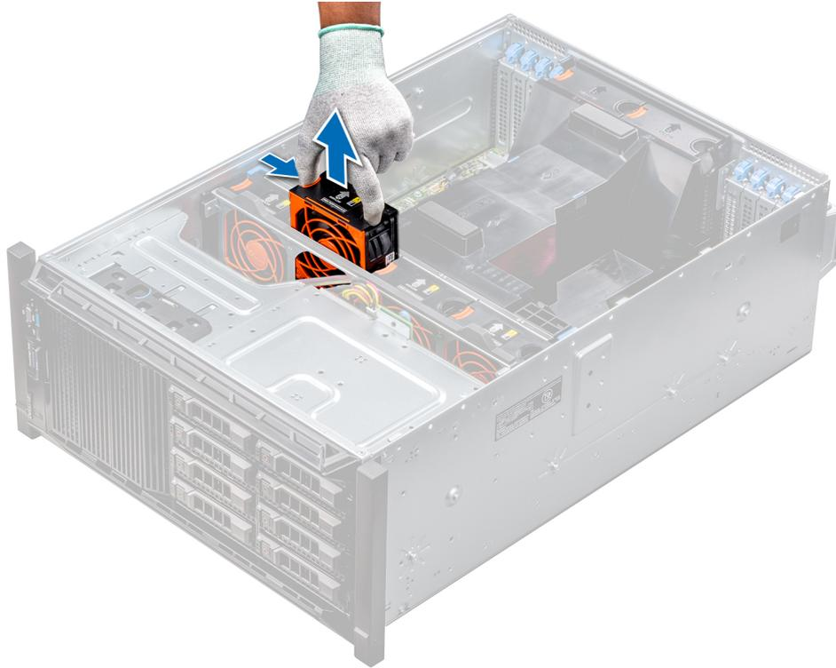
Figure 47. Retrait d'un ventilateur de refroidissement central
