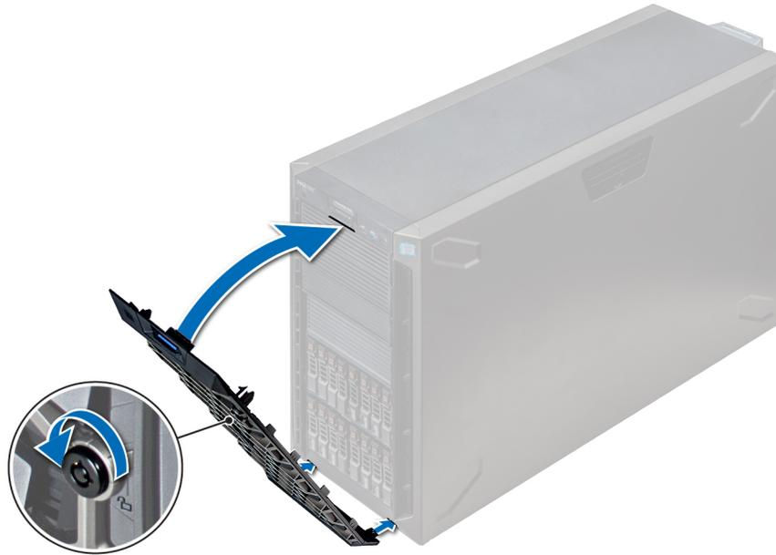
Figure 22. Installation du cadre avant
