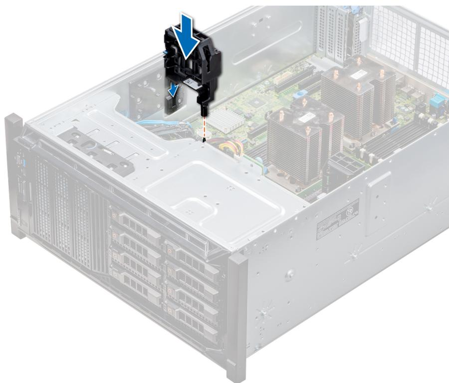
Figure 76. Installation du support de carte GPU
