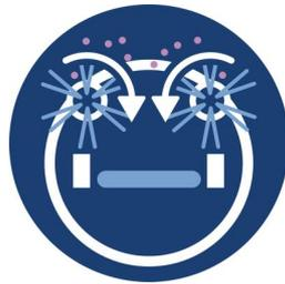
首先，兩柄長刷將髒汙及灰塵掃入機器人的行進路徑。接著，吸嘴和強力馬達會將髒汙及灰塵完全吸入。最後，一按即用拖淨清潔墊會帶走地板上最細微的灰塵，讓家居環境無比乾淨。
