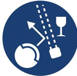
虛擬牆會建立起機器人無法跨越的隱形柵欄。這些隱形柵欄可用於限制機器人進入特定房間或區域，也可以預防機器人太過接近電線或電腦纜線、地板上的精細物品等等。虛擬牆最多可延伸約 2 公尺。
