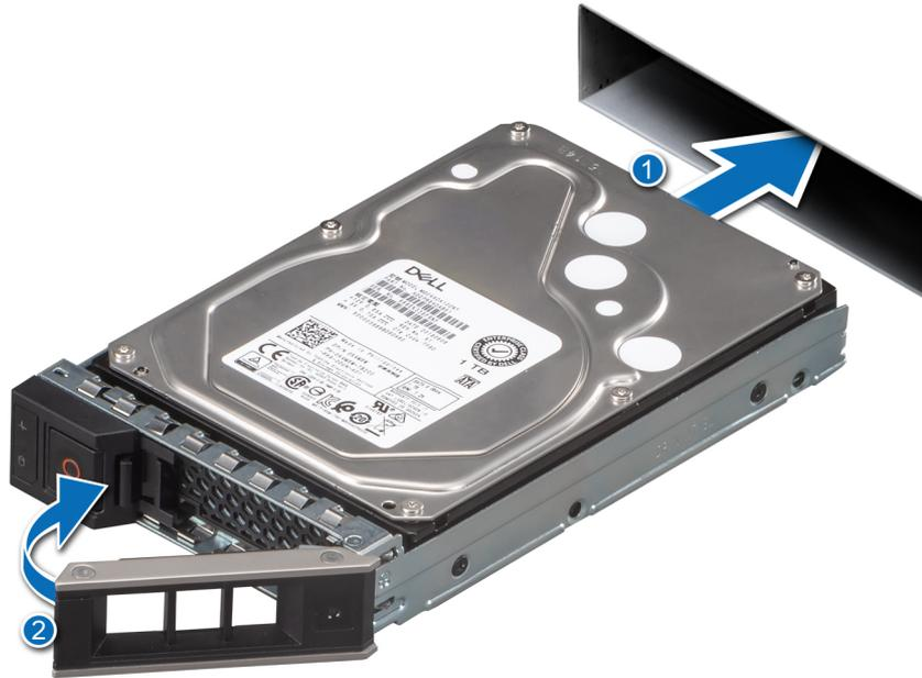
Figura 22. Instalación de la unidad de intercambio activo
