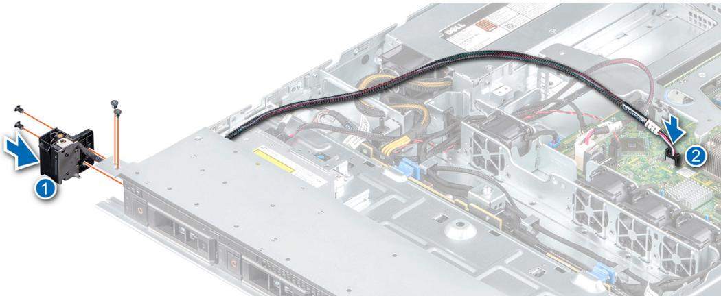
Figura 76. Instalación del panel de control izquierdo
