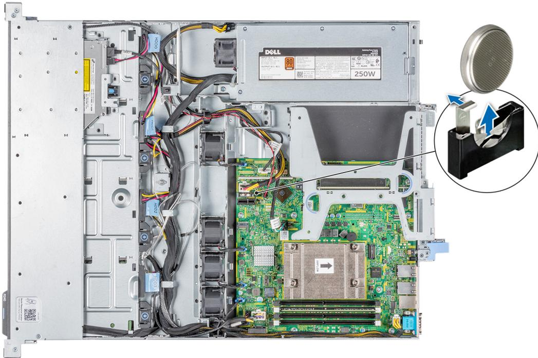
**Figura 49. Extracción de la batería del sistema**
