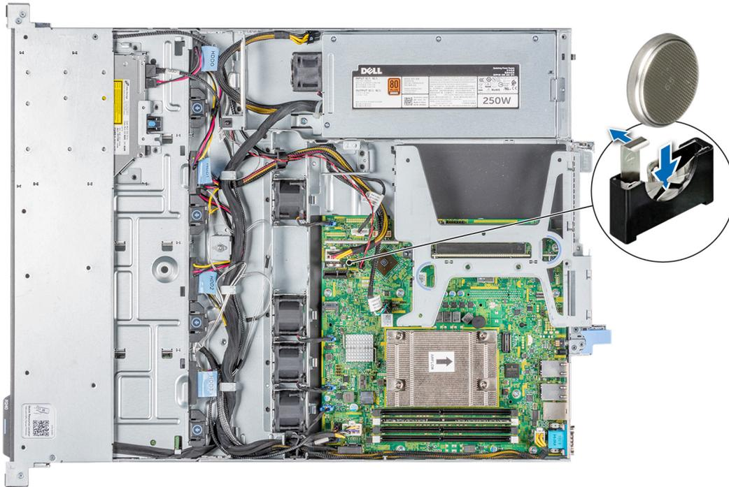
**Figura 50. Instalación de la batería del sistema**
