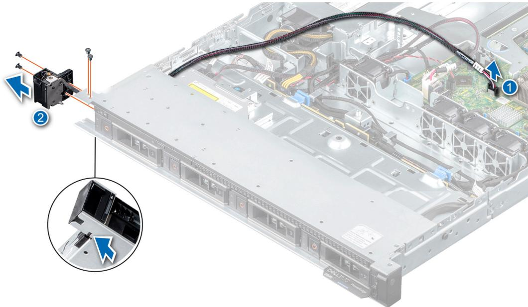
Figura 75. Extracción del panel de control izquierdo
