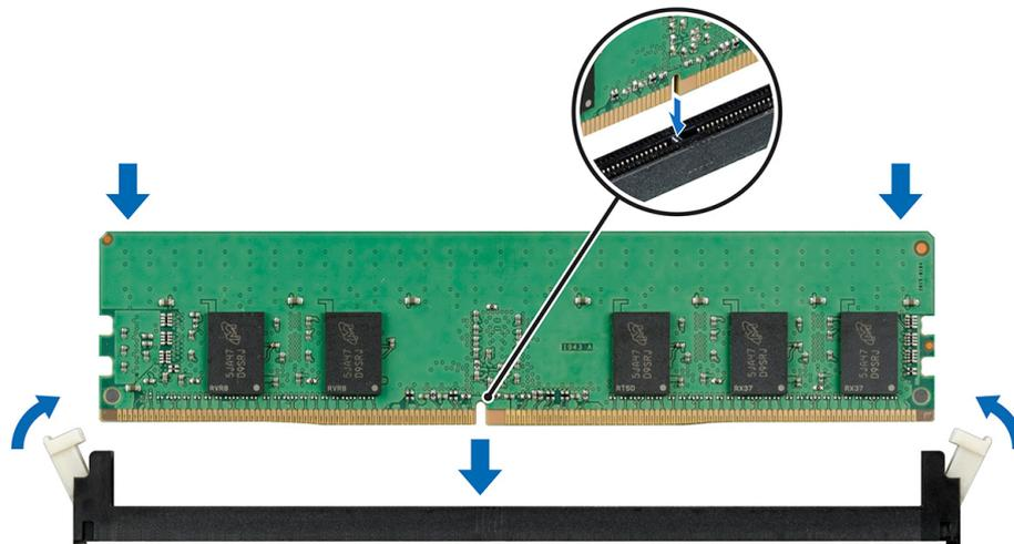
Figura 37. Instalación de un módulo de memoria
