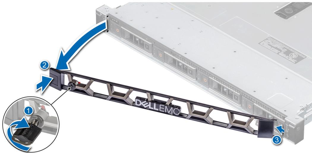
Figura 9. Extracción del bisel frontal
