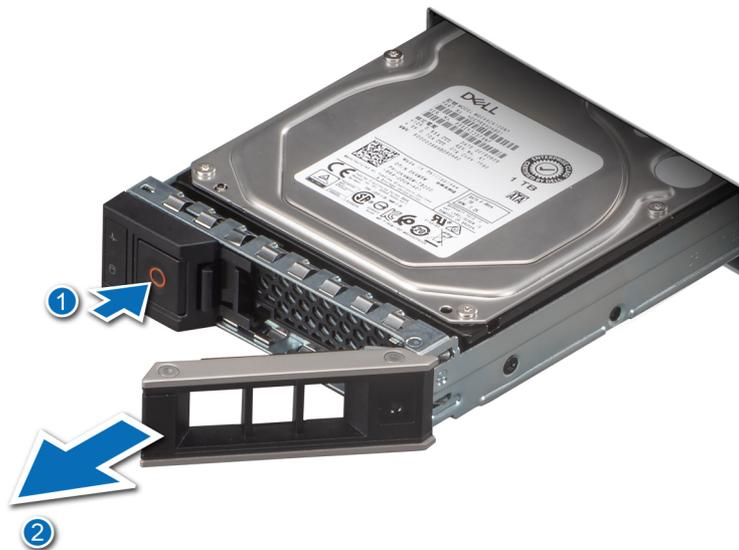
Figura 21. Extracción de una unidad de intercambio activo
