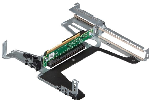
Figura 38. Soporte vertical para tarjetas de expansión
