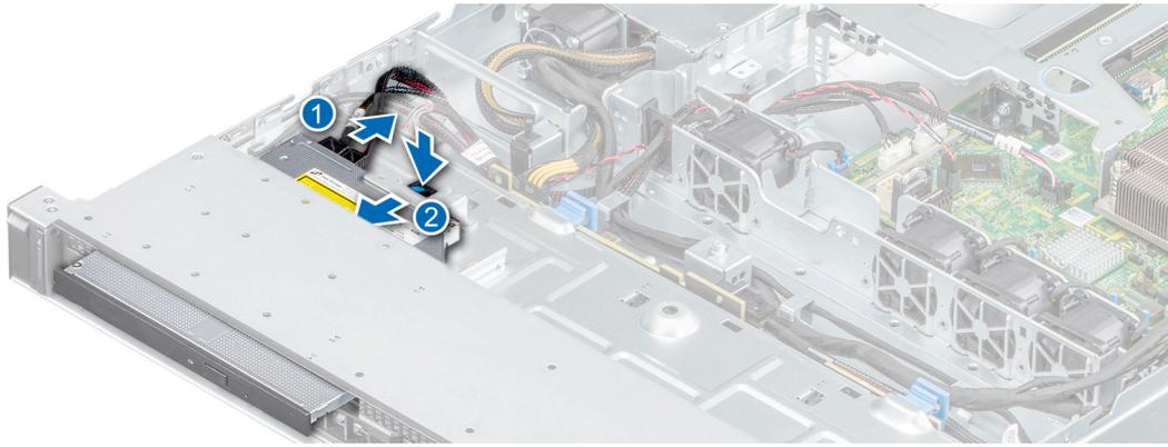
Figura 51. Extracción de la unidad óptica opcional
