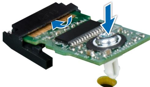
Figura 74. Instalación del TPM
