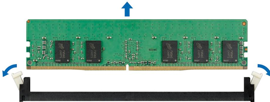
Figura 36. Extracción de un módulo de memoria
