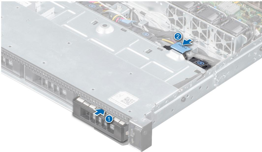
Figura 30. Instalación de una unidad cableada
