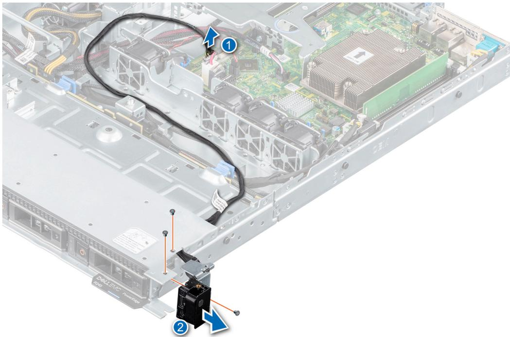
Figura 77. Extracción del panel de control derecho
