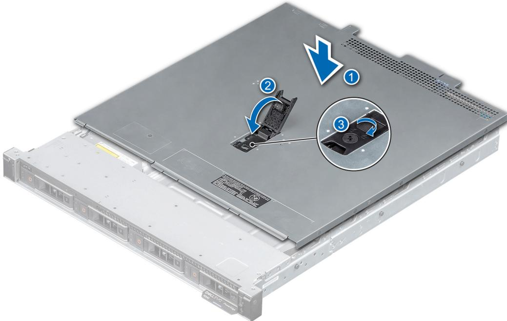
Abbildung 16. Installieren der Systemabdeckung
