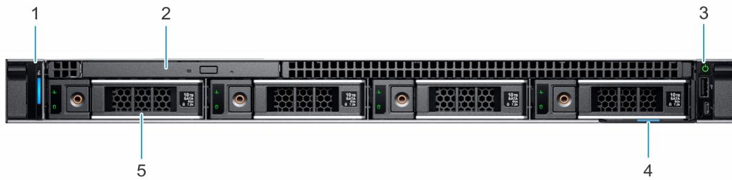
**Abbildung 2. Vorderansicht des Systems mit 4 x 3,5-Zoll-Laufwerken**
