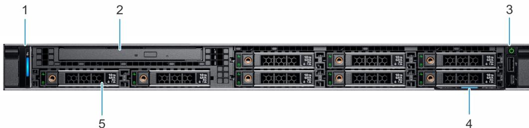
**Abbildung 1. Vorderansicht des Systems mit 8 x 2,5-Zoll-Laufwerken**
