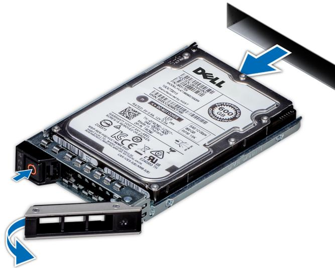
Abbildung 25. Entfernen des Laufwerkträgers
