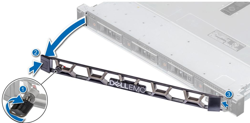
Abbildung 13. Entfernen der optionalen Frontverkleidung (Blende)
