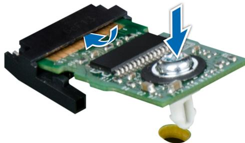
Abbildung 77. Installieren des TPM-Moduls
