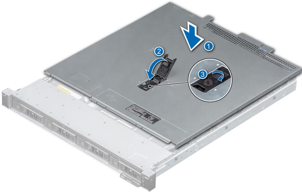
Figura 16. Instalación de la cubierta del sistema
