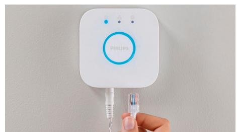
Die Hue Bridge\* ist die Schaltzentrale Deines smarten Lichtsystems. Sie verknüpft Deine Hue White & Color Ambiance Smart Lights mit Deiner App und der Sync Box. Du kannst Deine synchronisierten Lichteinstellungen anpassen und speichern. \*Die Sync Box ist nur mit der quadratischen Philips Hue Bridge Version 2 kompatibel.
