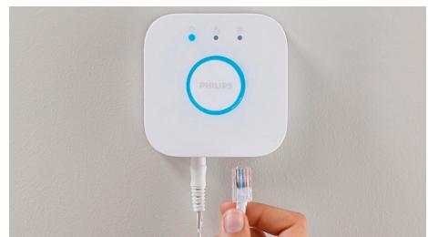
El Hue Bridge\* es el alma de tu sistema de iluminación inteligente, conecta tus luces inteligentes Hue White y color ambiance a tu aplicación y a la sync box, lo que te permite personalizar y guardar tus ajustes de iluminación al sincronizar. \*La sync box solo es compatible con el Hue Bridge V2 cuadrado.
