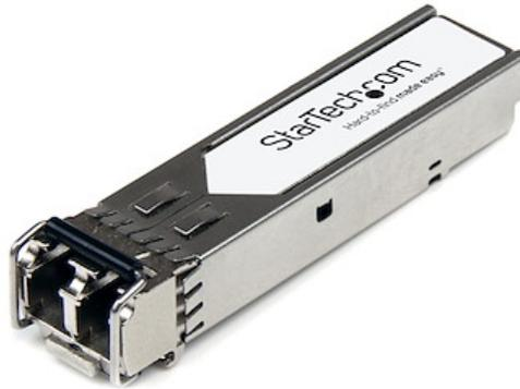
El modelo 0231A0A8-ST es un módulo transceptor SFP+ por fibra óptica compatible con el modelo 0231A0A8 de HP diseñado, programado y probado para su funcionamiento con routers y switches de la marca HP®. Ofrece conectividad confiable a 10 GbE, a través de cable de fibra óptica, para redes compatibles con 10GBase-LR, a una distancia máxima de hasta 10 km.
