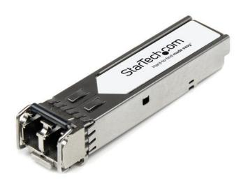
Le 10051-ST est un module de transceiver SFP fibre optique compatible Extreme Networks 10051 qui a été conçu, programmé et testé pour fonctionner avec des commutateurs et des routeurs de marque Extreme Networks®. Il vous assure une connectivité de 1 GbE par câble en fibre optique, sur les réseaux compatibles 1000Base-SX et sur une distance maximale de 550 m.
