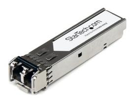
El modelo 10301-ST es un módulo transceptor SFP+ por fibra óptica compatible con el modelo 10301 de Extreme Networks diseñado, programado y probado para su funcionamiento con routers y switches de la marca Extreme Networks®. Ofrece conectividad confiable a 10 GbE, a través de cable de fibra óptica, para redes compatibles con 10GBASE-SR, a una distancia máxima de hasta 300 m.
