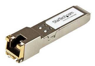
El modelo 10301-T-ST es un módulo transceptor SFP+ por cobre compatible con el modelo 10301-T de Extreme Networks diseñado, programado y probado para su funcionamiento con routers y switches de la marca Extreme Networks®. Ofrece conectividad confiable a 10 GbE, a través de cable de cobre, para redes compatibles con 100/1000/10000BASE-TX, a una distancia máxima de hasta 30 m.
