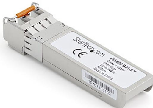
El modelo 455889-B21-ST es un módulo transceptor SFP+ por fibra óptica compatible con el modelo 455889-B21 de HPE diseñado, programado y probado para su funcionamiento con routers y switches de la marca HPE®. Ofrece conectividad confiable a 10 GbE, a través de cable de fibra óptica, para redes compatibles con 10GBASE-LRM, a una distancia máxima de hasta 200 m.
