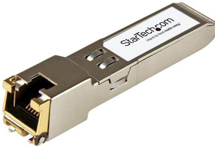
Le AR-SFP-10G-T-ST-ST-ST est un module de transceiver SFP+ cuivre compatible Arista Networks SFP-10G-T qui a été conçu, programmé et testé pour fonctionner avec des commutateurs et des routeurs de marque Arista Networks®. Il vous assure une connectivité de 10 GbE par câble en cuivre, sur les réseaux compatibles 100/1000/10000Base-TX et sur une distance maximale de 30 m.
