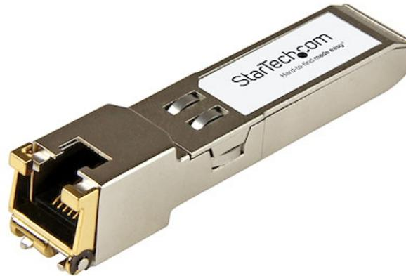
Der AR-SFP-10G-T-ST ist ein Arista Networks SFP-10G-T-kompatibles Kupfer SFP+-Transceiver-Modul, das für den Einsatz mit Arista Networks® Marken-Switches und -Routern entwickelt, programmiert und getestet wurde. Es sorgt für zuverlässige 10 GbE-Konnektivität über Kupfer-Kabel für 100/1000/10000BASE-TX-konforme Netzwerke mit einer maximalen Entfernung von bis zu 30m.
