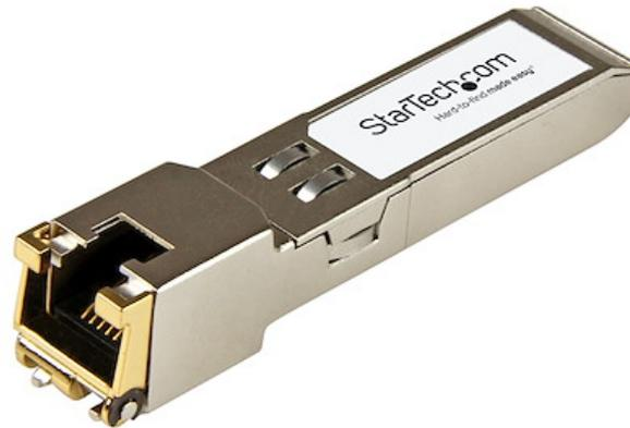
El modelo BRSFP-1GECOPR-ST es un módulo transceptor SFP por cobre compatible con el modelo BRSFP-1GECOPR de Brocade diseñado, programado y probado para su funcionamiento con routers y switches de la marca Brocade®. Ofrece conectividad confiable a 1 GbE, a través de cable de cobre, para redes compatibles con 10/100/1000BASE-TX, a una distancia máxima de hasta 100 m.
