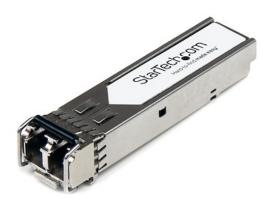
Der EW3A0000711-ST ist ein Citrix EW3A0000711-STkompatibles Glasfaser SFP+-Transceiver-Modul, das für den Einsatz mit Citrix® Marken-Switches und -Routern entwickelt, programmiert und getestet wurde. Es sorgt für zuverlässige 10 GbE-Konnektivität über Glasfaser-Kabel für 10GBASE-LR-konforme Netzwerke mit einer maximalen Entfernung von bis zu 10 km.
