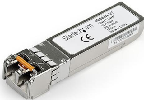
El modelo JD093A-ST es un módulo transeptor SFP+ por fibra óptica compatible con el modelo JD093A de HPE diseñado, programado y probado para su funcionamiento con routers y switches de la marca HPE®. Ofrece conectividad confiable a 10 GbE, a través de cable de fibra óptica, para redes compatibles con 10GBASE-LRM, a una distancia máxima de hasta 200 m.
