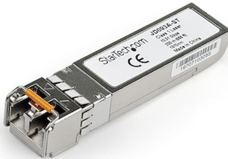
Der JD093A-ST ist ein HPE JD093A-kompatibles Glasfaser SFP+-Transceiver-Modul, das für den Einsatz mit HPE® Marken-Switches und -Routern entwickelt, programmiert und getestet wurde. Es sorgt für zuverlässige 10 GbE-Konnektivität über Glasfaser-Kabel für 10GBASE-LRM-konforme Netzwerke mit einer maximalen Entfernung von bis zu 200m.
