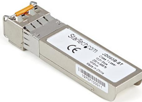
Der JD093B-ST ist ein HPE JD093B-kompatibles Glasfaser SFP+-Transceiver-Modul, das für den Einsatz mit HPE® Marken-Switches und -Routern entwickelt, programmiert und getestet wurde. Es sorgt für zuverlässige 10 GbE-Konnektivität über Glasfaser-Kabel für 10GBASE-LR-konforme Netzwerke mit einer maximalen Entfernung von bis zu 10 km.
