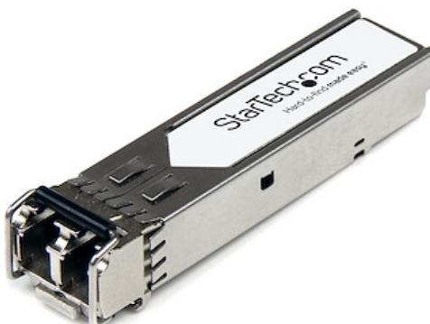
El modelo JD094A-ST es un módulo transceptor SFP+ por fibra óptica compatible con el modelo JD094A de HPE diseñado, programado y probado para su funcionamiento con routers y switches de la marca HPE®. Ofrece conectividad confiable a 10 GbE, a través de cable de fibra óptica, para redes compatibles con 10GBASE-LR, a una distancia máxima de hasta 10 km.
