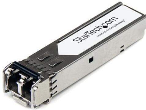
Le JD094A-ST est un module de transceiver SFP+ fibre optique compatible HPE JD094A qui a été conçu, programmé et testé pour fonctionner avec des commutateurs et des routeurs de marque HPE®. Il vous assure une connectivité de 10 GbE par câble en fibre optique, sur les réseaux compatibles 10GBASE-LR et sur une distance maximale de 10 km.
