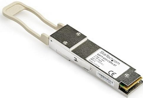
El modelo QSFP-40G-CSR4-ST4-ST4-ST4-ST4-ST es un módulo transceptor QSFP por fibra óptica compatible con el modelo QSFP-40G-CSR4-ST4-ST4-ST4-ST4 de Cisco diseñado, programado y probado para su funcionamiento con routers y switches de la marca Cisco®. Ofrece conectividad fiable a 40 GbE, a través de cable de fibra óptica, para redes compatibles con 40GBase-SR4, a una distancia máxima de hasta 400 m.
