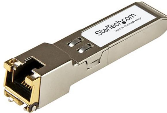
Der SFP-TX-ST ist ein Citrix SFP-TX-kompatibles Kupfer SFP+-Transceiver-Modul, das für den Einsatz mit Citrix® Marken-Switches und -Routern entwickelt, programmiert und getestet wurde. Es sorgt für zuverlässige 10 GbE-Konnektivität über Kupfer-Kabel für 10/100/1000BASE-TX-konforme Netzwerke mit einer maximalen Entfernung von bis zu 100m.
