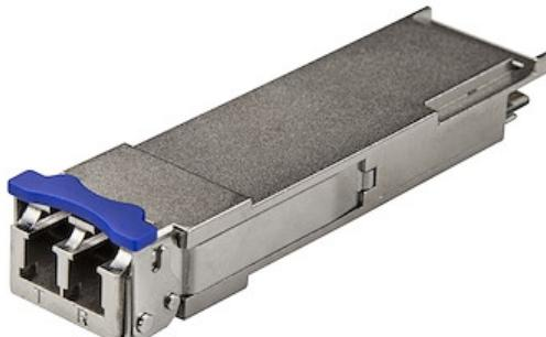
Le WSP-Q40GLR4L-ST est un module de transceiver QSFP fibre optique compatible Cisco WSP-Q40GLR4L-ST qui a été conçu, programmé et testé pour fonctionner avec des commutateurs et des routeurs de marque Cisco®. Il vous assure une connectivité de 40 GbE par câble en fibre optique, sur les réseaux compatibles 40GBASE-IR4 et sur une distance maximale de 2 km.
