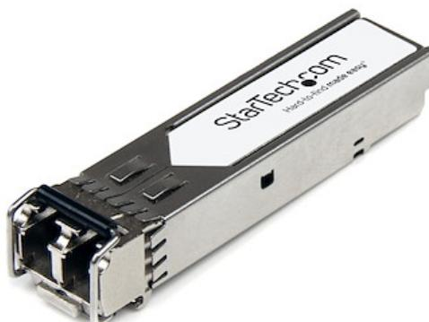
El modelo XG-SR-ST es un módulo transceptor SFP+ por fibra óptica compatible con el modelo XG-SR de Brocade diseñado, programado y probado para su funcionamiento con routers y switches de la marca Brocade®. Ofrece conectividad confiable a 10 GbE, a través de cable de fibra óptica, para redes compatibles con 10GBASE-SR, a una distancia máxima de hasta 300 m.
