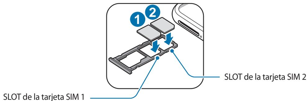
4 Presione suavemente la tarjeta SIM o USIM en el SLOT de la tarjeta SIM para ajustarla.
