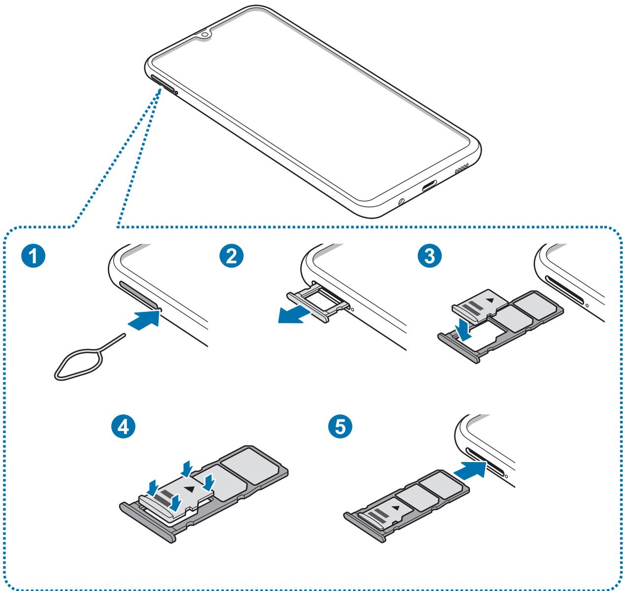
1 Coloque la clavija en el orificio ubicado al lado del SLOT para aflojar el SLOT.
