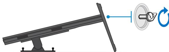
4. Schieben Sie den Entriegelungsriegel am Standrahmen, bis Sie ein Klicken hören, um die Abdeckung des Standrahmens zu lösen.
