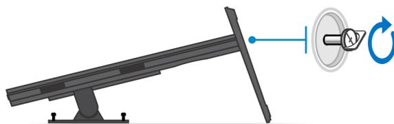
4. Faites glisser le loquet de dégagement situé sur le socle jusqu'à entendre un déclic, afin de débloquer le cache du socle.
