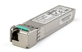
Der SFP10GBX10DS ist ein MSA-konformer Downstream Glasfaser SFP+-Transceiver, der mit SFP-10G-BX10-U von StarTech.com verbunden werden kann. Er wurde für den Einsatz mit 10GBASE-BX10-kompatiblen MSA-Switches und -Routern entwickelt. Das SFP+-Transceiver-Modul unterstützt eine maximale Entfernung von bis zu 10 km und sorgt für zuverlässige 10 GbE-Konnektivität via Glasfaser-Verkabelung.
