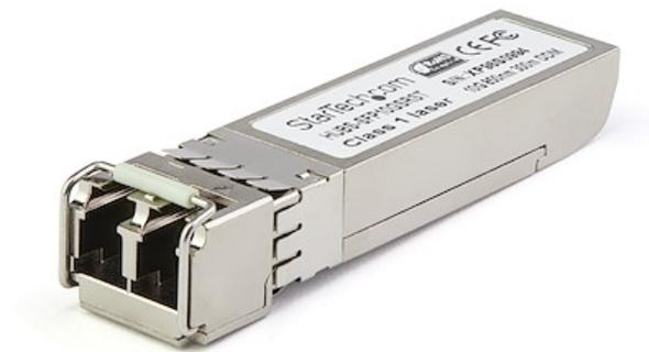
El modelo SFP10GLREMST es un módulo transceptor SFP+ por fibra óptica compatible con el modelo SFP-10G-LR de Dell EMC diseñado, programado y probado para su funcionamiento con routers y switches de la marca Dell EMC™. Ofrece conectividad confiable a 10 GbE, a través de cable de fibra óptica, para redes compatibles con 10GBASE-LR, a una distancia máxima de hasta 10 km.
