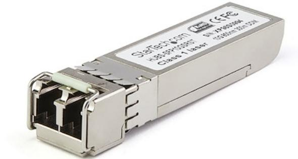
Le SFP10GSREMST est un module de transceiver SFP+ fibre optique compatible Dell EMC SFP-10G-SR qui a été conçu, programmé et testé pour fonctionner avec des commutateurs et des routeurs de marque Dell EMC™. Il vous assure une connectivité de 10 GbE par câble en fibre optique, sur les réseaux compatibles 10GBASE-SR et sur une distance maximale de 400 m.
