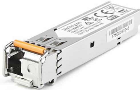
El modelo SFP1GBX10DES es un transceptor SFP downstream por fibra óptica compatible con el modelo SFP-1G-BX10-D de Dell EMC, que se puede emparejar con SFP1GBX10UES de StarTech.com. Ha sido diseñado, programado y probado para su funcionamiento con routers y switches MSA compatibles con 1000Base-BX10. El módulo transceptor SFP+ admite una distancia máxima de hasta 10 km y conectividad confiable a 1 GbE a través de cableado de fibra óptica.
